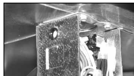
4 - Installing the grommet
