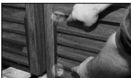
1a - Removing louvered grill (slide door model)
