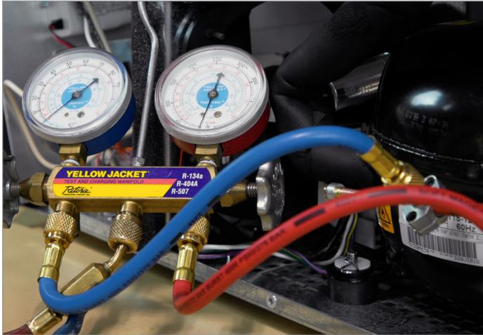
Utilisez les flexibles de réfrigérant les plus courts possibles vers vos manomètres (du fait de la charge de réfrigérant réduite).
