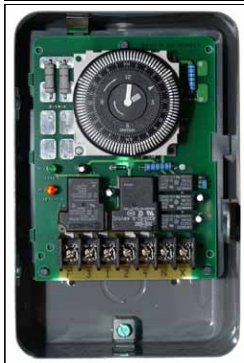
1 Коробка таймера оттаивания
