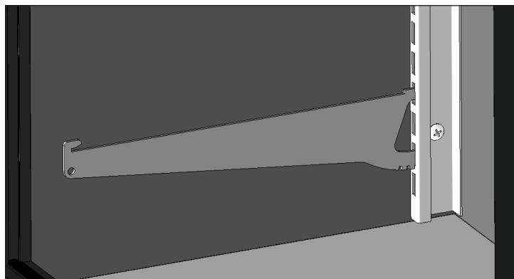
Fig. 4. Fixation de support d'étagère installée.
