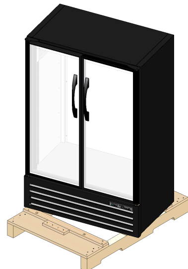
Fig. 3. Al levantar la unidad no utilice las encimeras, puertas/cajones o rejillas como punto de elevación.
