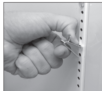
Fig. 11. La pestaña inferior del elemento de fijación encajará firmemente.
