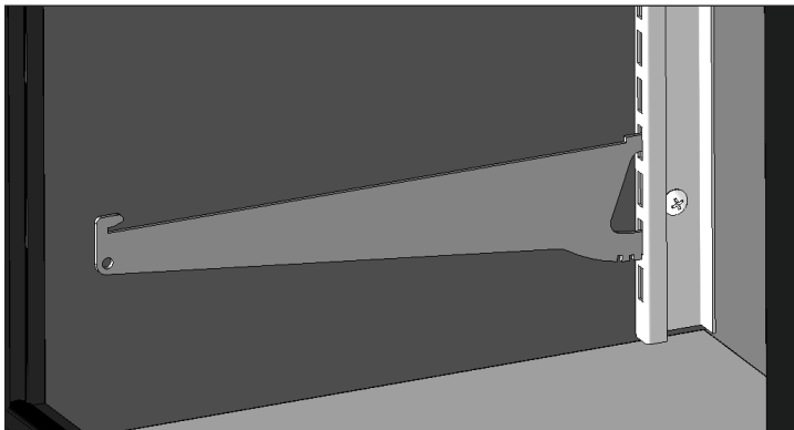
Fig. 4. Ménsula para el soporte del estante instalada.
