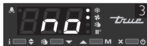
Рис. 3: Если появился символ «no», контроллер разблокирован.
