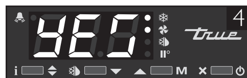
Рис. 4: Если появился символ «yes», контроллер заблокирован.
