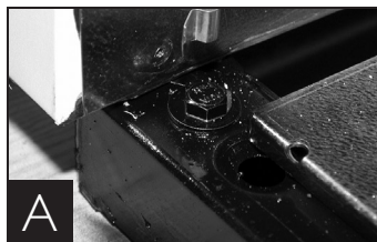
Демонтаж транспортировочной подставки с днища шкафа.
