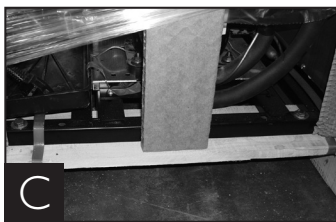
Entfernen der Palette von der Unterseite des Schrankes.
