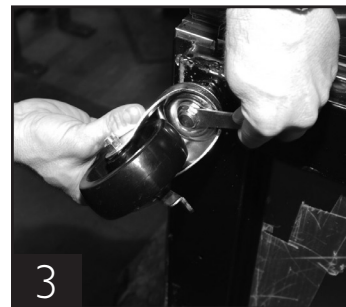
3 Gebruik het meegeleverde gereedschap om het wiel op zijn plaats aan te draaien.
