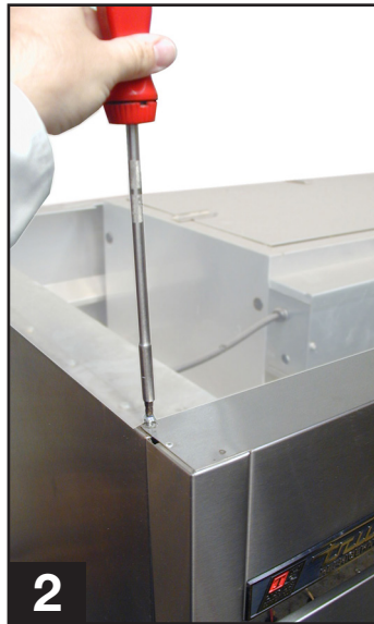
2 Congelador de Tres Puertas (Remoción de los tornillos superiores del Protector de Lluvia)
