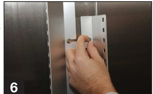
Instalación de las Pilastras (Pared Trasera del Gabinete / Modelos de Dos y Tres Puertas)
