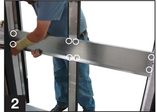
2 Remoción de los soportes. Localización de los tornillos plásticos.
