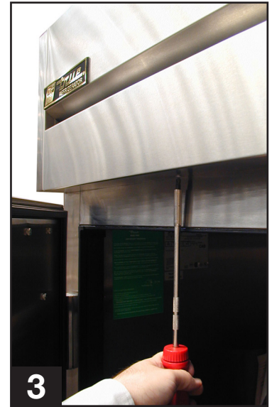
3 Congelador de Tres Puertas (Remoción de los tornillos inferiores del Protector de Lluvia)
