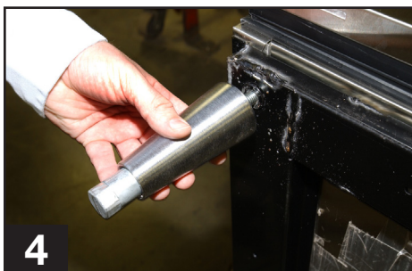
Atornille la pata en la parte inferior de la base del gabinete.
