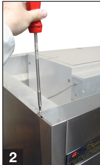
2 Vriezer met drie deuren (verwijderen regenscherm/ bovenste schroeven)
