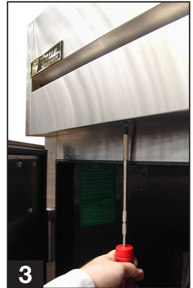
3 Vriezer met drie deuren (verwijderen regenscherm/ onderste schroeven)
