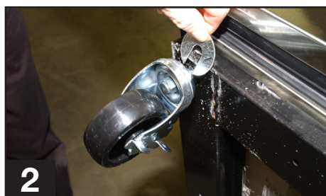
Installeer de shim tussen het wiel en de framerail om waterpas te zetten.
