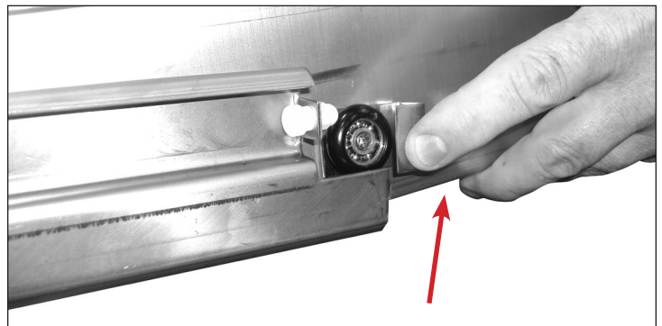
Fig. 4. Levante con cuidado el cajón del riel.
