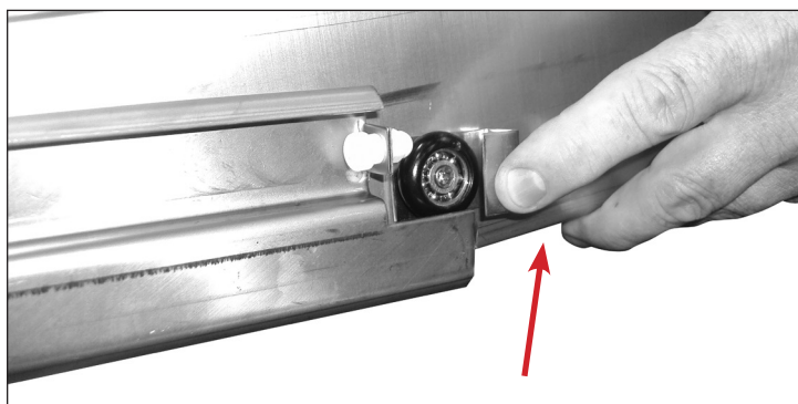
Fig. 4. Levantar com cuidado a gaveta das ranhuras do canal.
