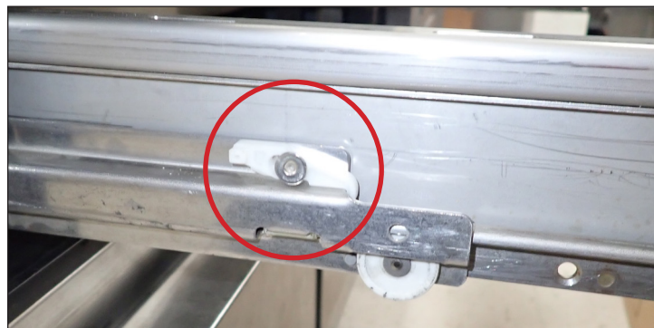
Fig. 1. Emplacement de la bague d'arrêt du tiroir. La bague d'arrêt est enclenchée.
