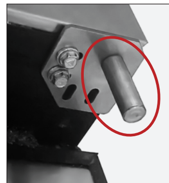
Fig. 2. No rompa el casquillo de la bisagra superior.
