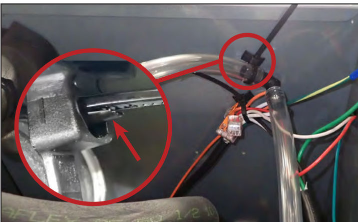
Fig. 3. Ubicación de la lengüeta de liberación de la brida.
