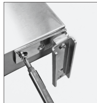
Рис. 5. Удалите блок-шарнир в сборе.
