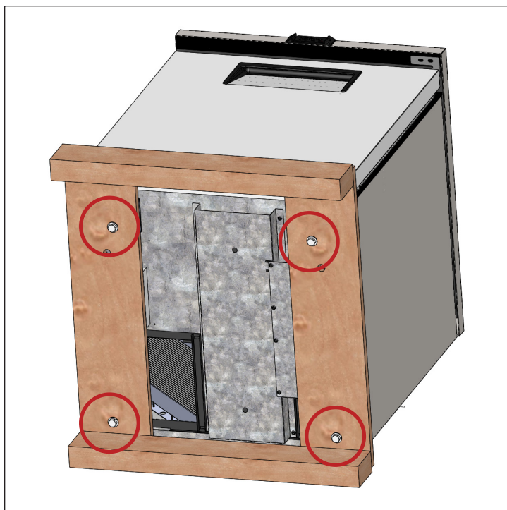
Rys. 3. Usunąć śruby transportowe.
