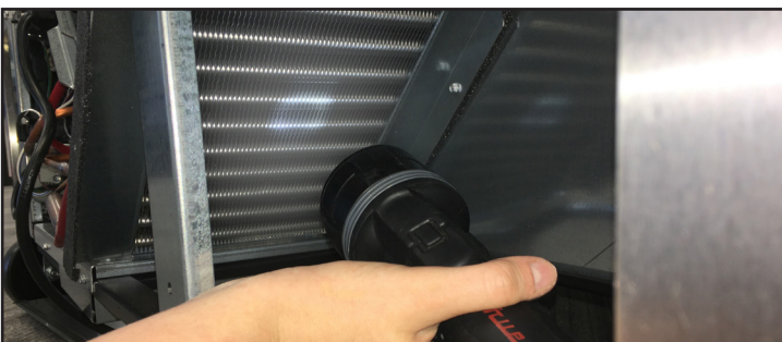
Rys. 4. Sprawdzić, czy wszystkie zatory zostały usunięte.
