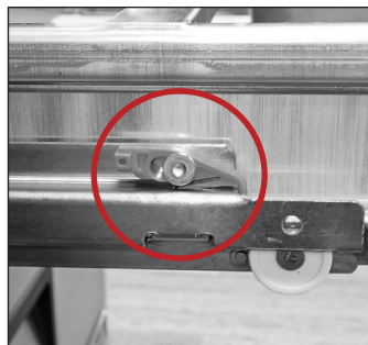
Rys. 5. Lokalizacja ogranicznika szuflady. Ogranicznik zablokowany.
