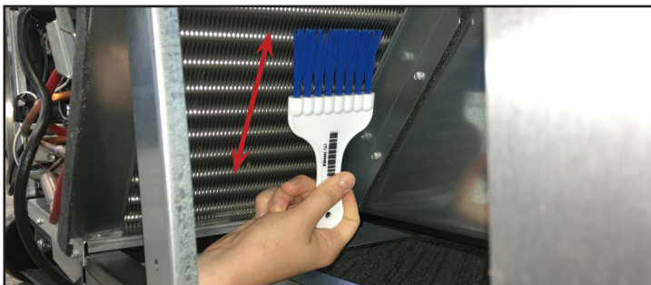
Rys. 3. Nigdy nie szczotkować żeber wężownicy.
