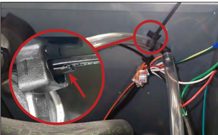
Abb. 3. Lage der Entriegelungslasche des Kabelbinders.
