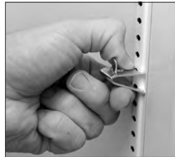
Abb. 3. Die Lasche muss zur Anbringung möglicherweise zusammengedrückt oder gedreht werden.
