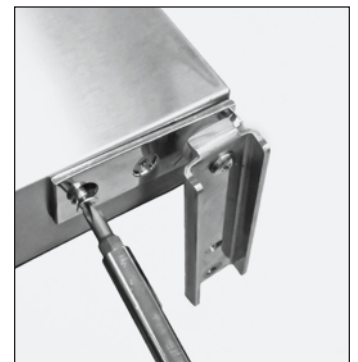
Abb. 5. Die Hülsenscharnier-Baugruppe entfernen.
