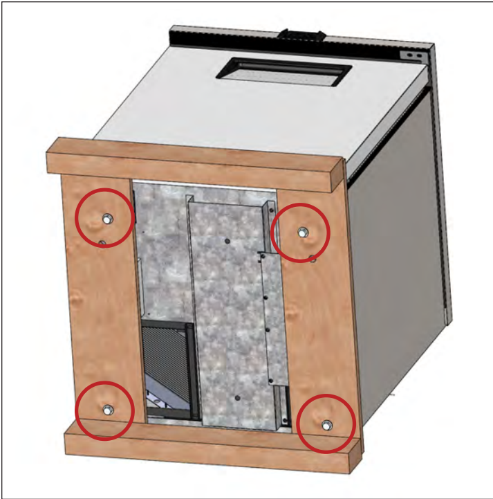
Fig. 3. Retrait de tous les boulons d'expédition.
