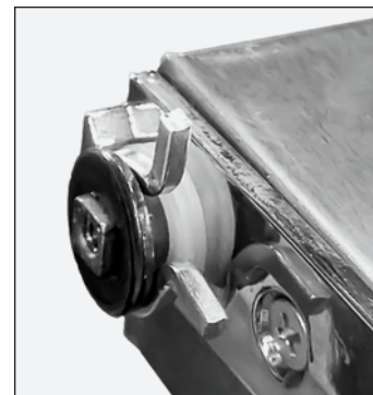
Afb. 7. Bewaar de sluitringen in de oorspronkelijke volgorde.
