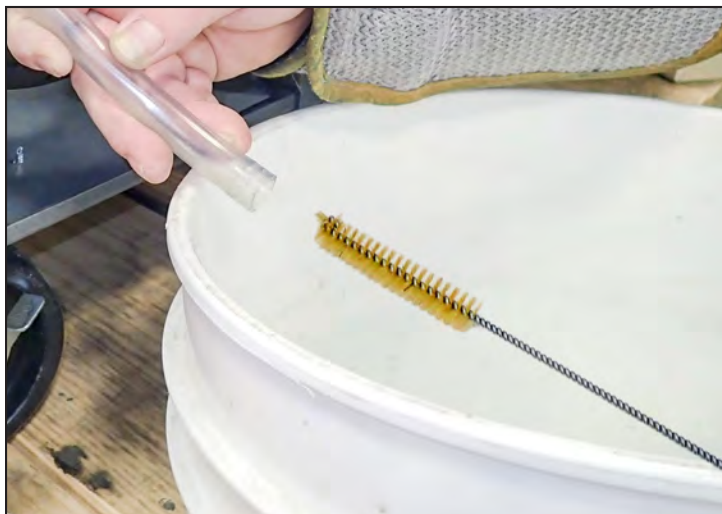
Afb. 2. Vang de geblokkeerde vloeistof op in een grote bak.
