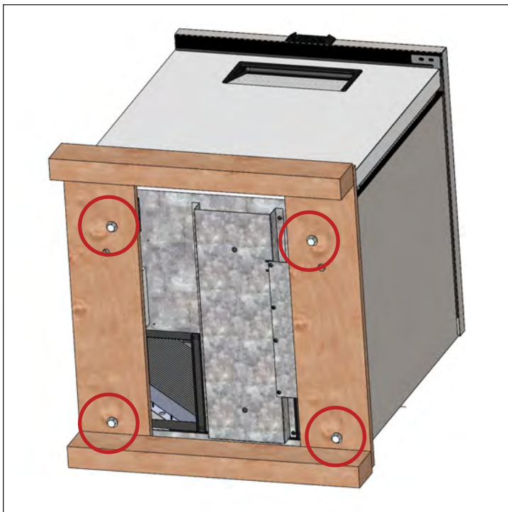
Afb. 3. Verwijder alle transportbouts.
