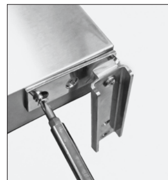
Afb. 5. Verwijder de scharnierset.
