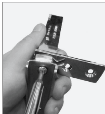
Afb. 6. Verwijder de scharnierbeugel uit het veerblok en draai deze vervolgens.
