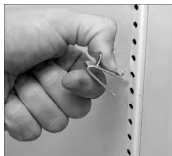
Afb. 1. De bovenste lip van de plankdrager monteren.
