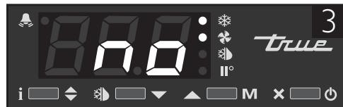
Slika 3: Ako se na zaslonu pojavi "no" (ne), tada je upravljački sklop otključan.
