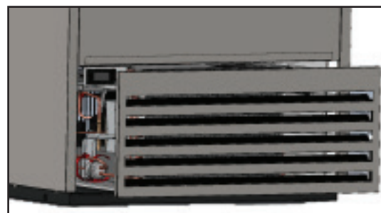
Рис. 2. Снять решетку.
