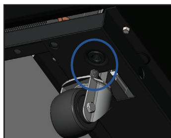
Rys. 6. Poluzować śrubę kółka.
