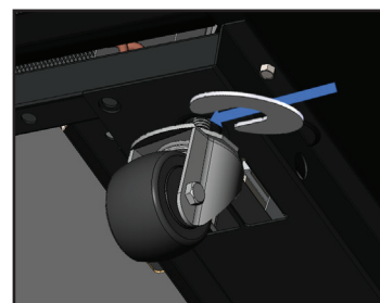
Rys. 7. Włożyć podkładkę(i).
