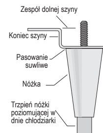
Rys. 4. Wkręcić nóżki poziomujące.
