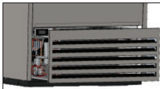
Rys. 2. Wykręcić śruby.
