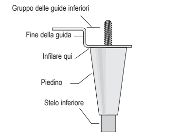
Fig. 4. Avvitare le gambe di livellamento.
