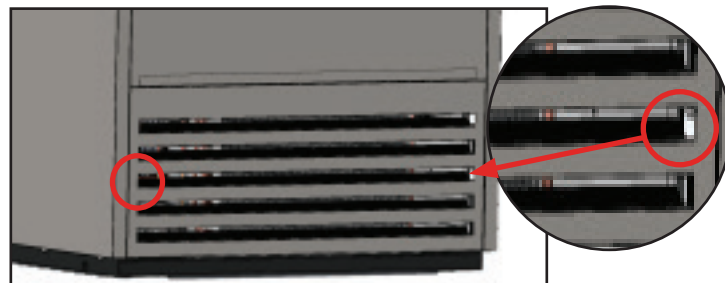
Fig. 1. Togliere la vite che assicura la griglia anteriore.
