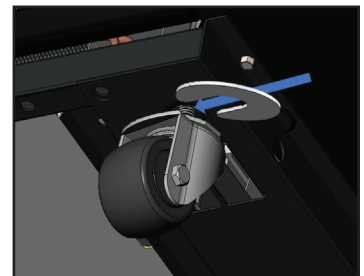
Fig. 7. Installare la/le zeppa/e.
