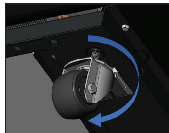
Fig. 8. Posizionare più zeppe ad angoli di 90°.
