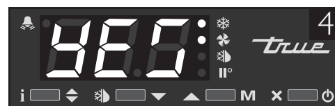
Рис. 4: Если появился символ «yes», контроллер заблокирован.
