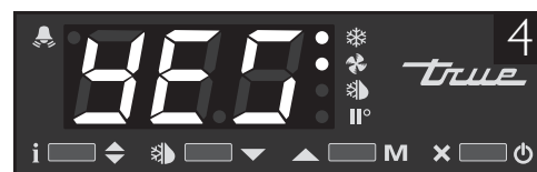
Figura 4 : Se « yes » (sì) compare sullo schermo, il regolatore è bloccato.
