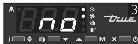
Afbeelding 3: Als er 'no' op het scherm wordt weergegeven, is de thermostaat ontgrendeld.
