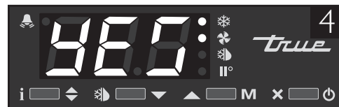
Bild 4: Wenn am Bedienteil „yes“ angezeigt wird, ist der Regler gesperrt.
