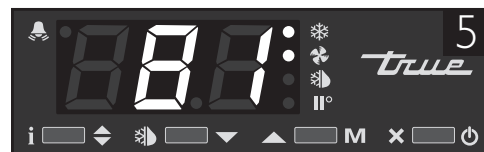
Bild 4: Wenn am Bedienteil „yes“ angezeigt wird, ist der Regler gesperrt.
