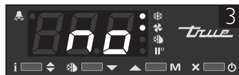
Bild 3: Wenn am Bedienteil „no“ angezeigt wird, ist der Regler entsperrt.
