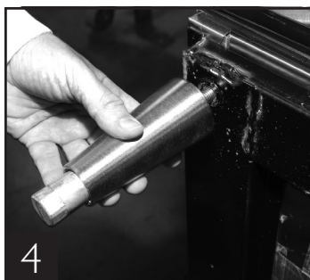
4 Fixer le pied sous le rail du cadre du bac.
