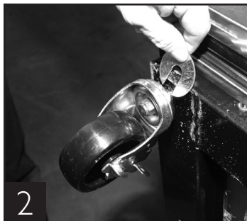
2 Pour la mise à niveau, insérer une rondelle entre la roulette et le rail du cadre.
