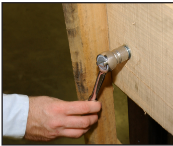
Loshalen van de pallet van de onderkant van de kast.
