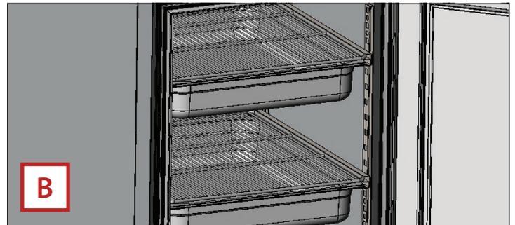
Fig. 6. Si lo desea, deslice las bandejas de producto en los canales. Las bandejas de producto no están incluidas.
