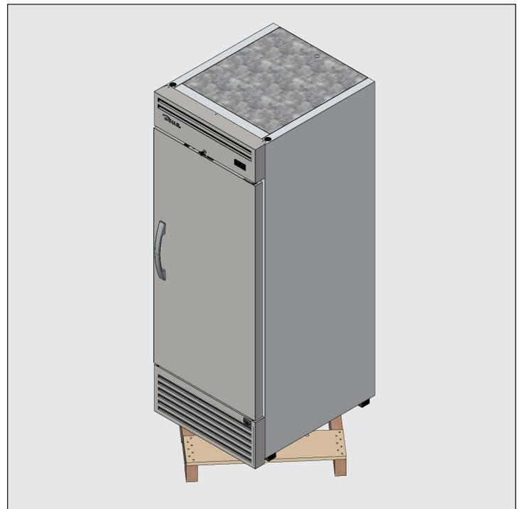
**Fig. 3.** Al elevar la unidad, no use encimeras, puertas, cajones ni rejillas como punto de elevación.
