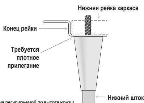
Рис. 4. Схема регулируемой по высоте ножки.
