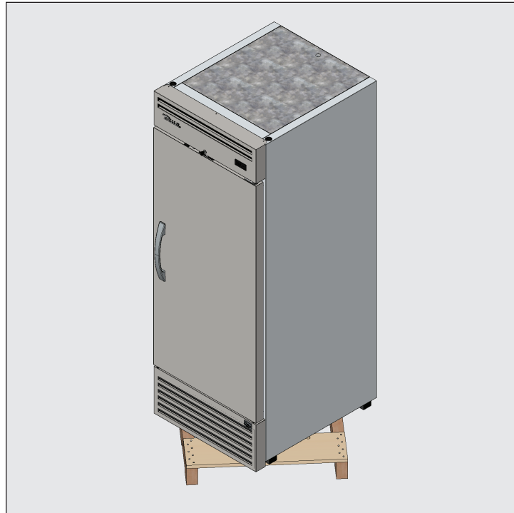
Figure 3. Pour le levage de l'appareil, ne pas utiliser les plans de travail, les portes/tiroirs ni les grilles comme point de levage.
