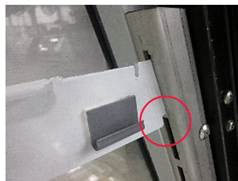
Muesca superior instalada (brecha)
