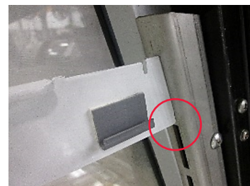
Encoche inférieure installée (sans interstice)
