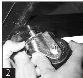
Atomille las ruedas en los orificios de los niveladores.
