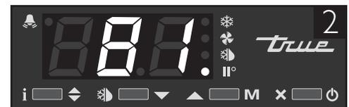
**PASO 1** - Para cambiar el rango de temperatura presione y suelte el Botón de Activación Manual en el controlador:
