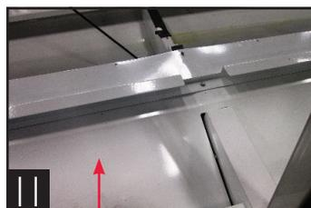
11 Illustration du couvercle de l'évaporateur au centre du modèle TDMR-77.
