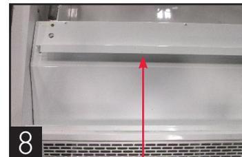
8 Support monté sur le dessus des couvercles
