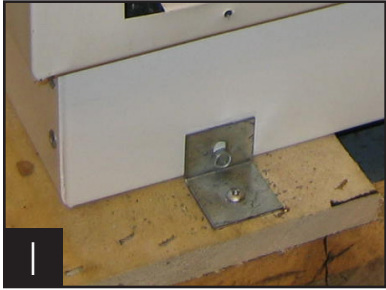
Fotografía I: Removiendo los soportes de la base que fijan la unidad a la paleta.
