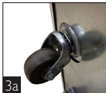
Installation des roulettes
