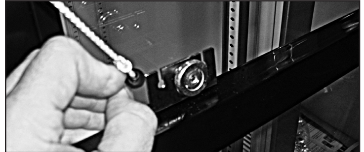
Abb. 8 Der schwarze Schnurhalter wird nach hinten geschoben und so aus der Öse entfernt.
