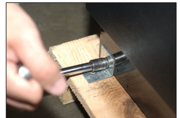
Abb. 3 Sofern vorhanden, den Sicherungsansatz entfernen.
