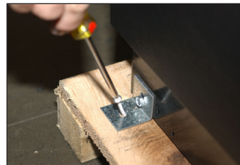
Abb. 3 Sofern vorhanden, den Sicherungsansatz entfernen.
