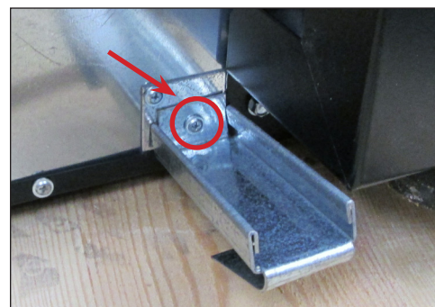
Fig. 5. Dévissez tous les supports de l'appareil, comme indiqué par le cercle. La flèche indique l'emplacement de la plaque métallique arrière.
