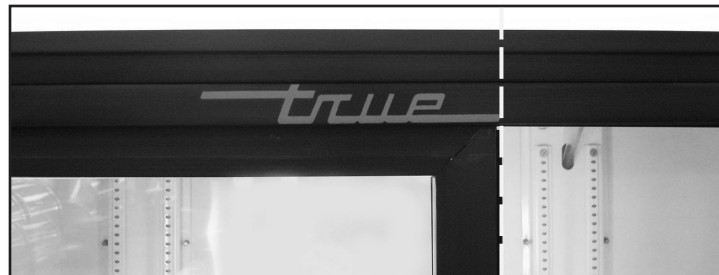
Fig. 6. Alignez le bord droit de la porte gauche avec le bord droit du logo TRUE.
