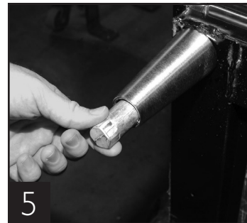
5 El extremo del pie es ajustable para una fácil nivelación.
