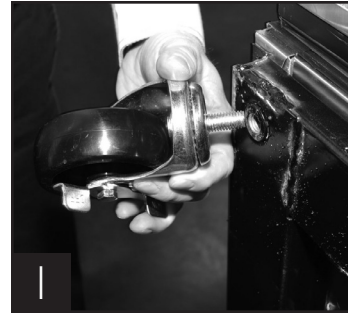
1 Rueda con espiga roscada en la parte inferior del marco del riel del armario.
