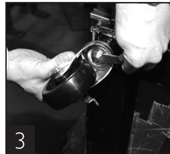
3 Use la herramienta suministrada para apretar la rueda en su posición final.
