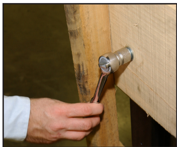
Desmontaje de la plataforma de la parte inferior del armario.
