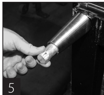
5 Koniec nogi jest regulowany, aby ułatwić poziomowanie.
