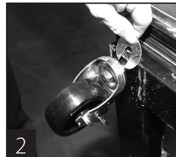
2 W celu wy poziomowania, włożyć podkładkę między kółko a szynę ramy.
