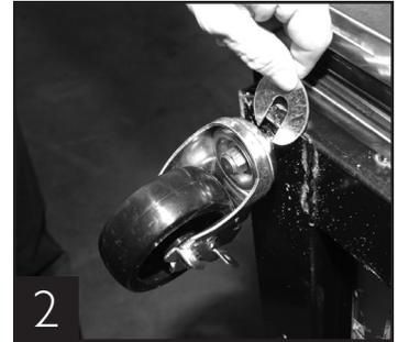
2 Pour la mise à niveau, insérez la cale entre la roulette et le rail du châssis.
