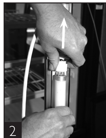
Retirer l'ampoule en la remontant légèrement sur la douille à ressorts.
