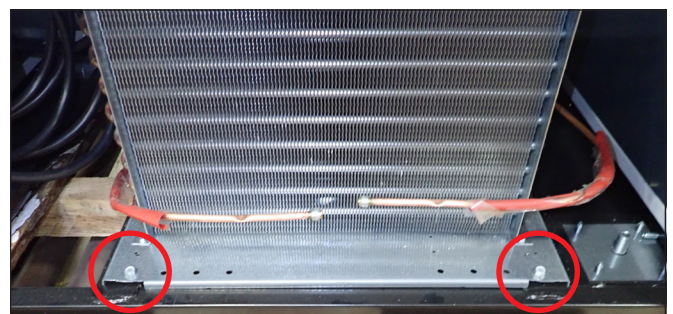
Fig. 4. Retire los pernos de la base del condensador.
