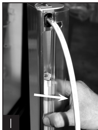
Apriete el protector de la lámpara y gírelo hacia fuera.
