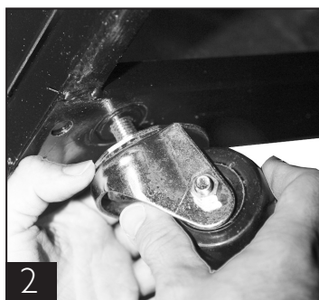
Atornille las ruedas en los orificios de los niveladores.
