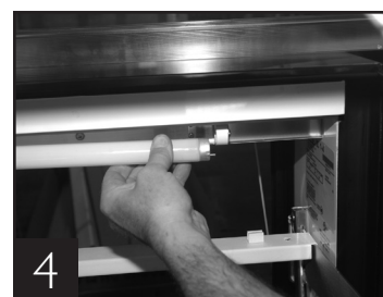
Remueva el bulbo empujándolo gentilmente hacia el soporte de la lámpara.
