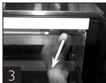
Appuyer sur l'écran protecteur et le tourner vers l'extérieur.
