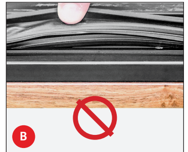
Fig. 12. Tire del lado de la junta para comprobar que la instalación es correcta. A: CORRECTO; el surco de la junta NO es visible. B: INCORRECTO; el surco de la junta es visible.
