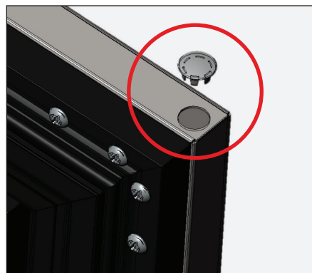
Fig. 11. Instale el tapón.
