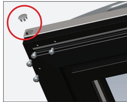
Fig. 5. Retire los tapones de la puerta y los tornillos restantes.
