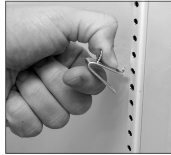
Fig. 1. Instalación de la pestaña superior del elemento de fijación.
