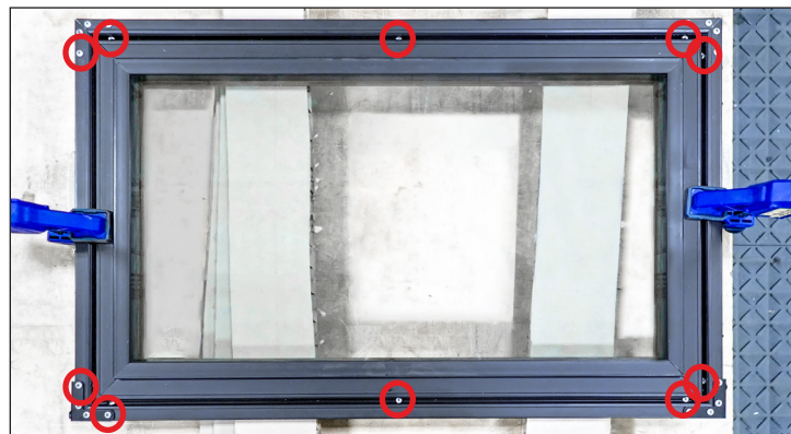
Рис. 7. Расположение предварительно просверленных отверстий двери шкафа.
