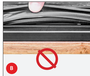
Рис. 12. Потяните сбоку за уплотнитель, чтобы проверить то, как он установлен. A: ПРАВИЛЬНО; направляющая уплотнителя НЕ видна. B: НЕПРАВИЛЬНО; направляющая уплотнителя видна.
