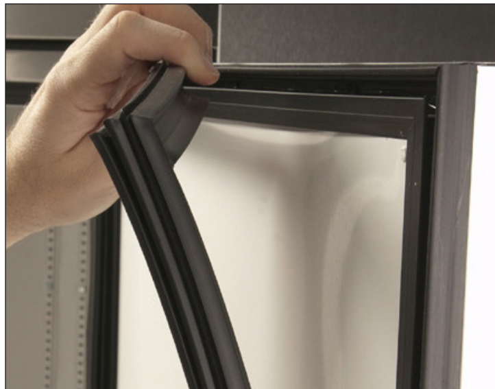
Рис. 2. Потяните за уплотнитель, начав в верхнем углу.
