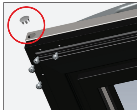
Рис. 5. Удалите заглушки двери и оставшиеся винты.
