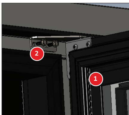
Рис. 10. Смонтируйте верхнюю петлю и дверь.
