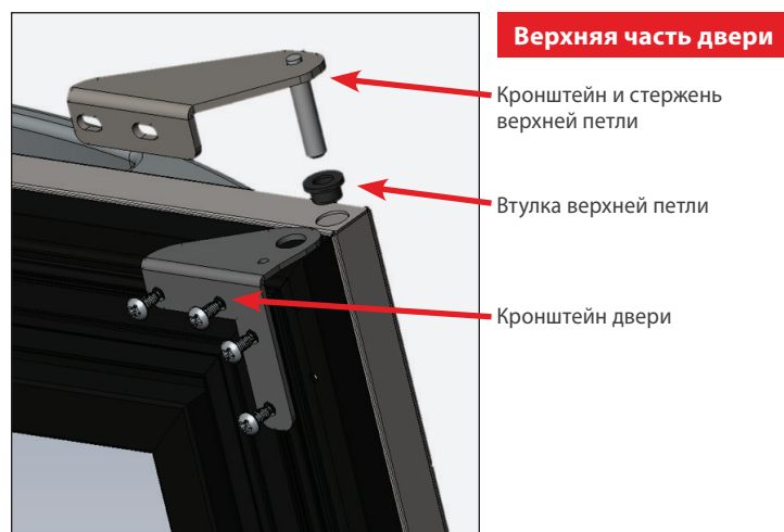
Рис. 4а. Компоненты верхней петли.
