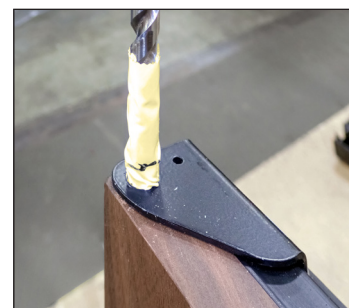
Рис. 9. Сначала просверлите отверстие 3/8". ЗАТЕМ просверлите отверстие 17/64".
