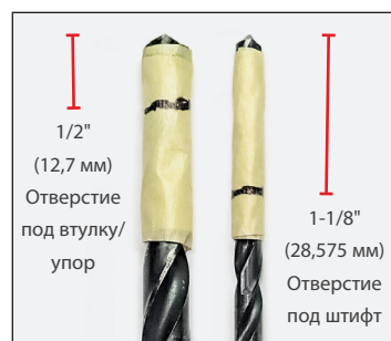
Рис. 8. Обозначьте глубину отверстий на сверлах.
