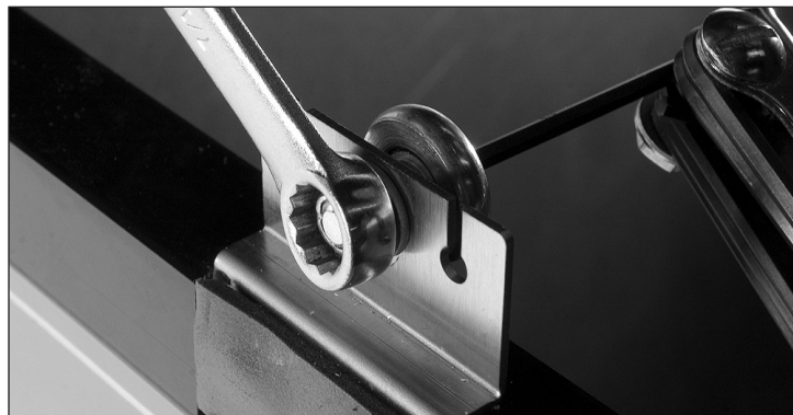
Рис. 1. Регулировка ролика.
