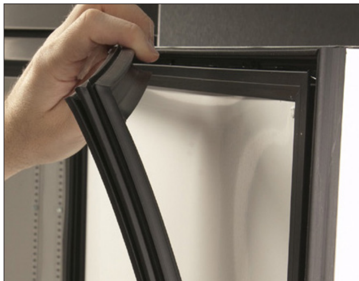
Rys. 2. Wyciągnięcie uszczelki zaczynając od górnego rogu.
