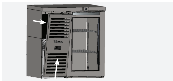
Rys. 2. Pociągnąć grill do przodu przed podniesieniem.
