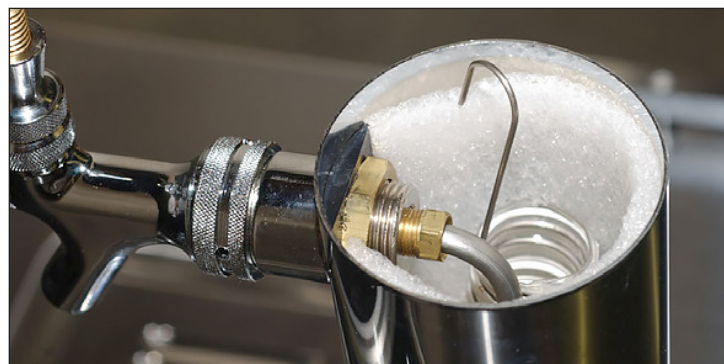
Rys. 8. Zawiesić zacisk węża chłodzącego ponad linią piwa.
