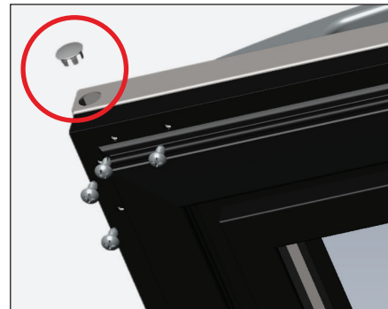
Rys. 5. Wyjąć zaślepki drzwi i pozostałe śruby.
