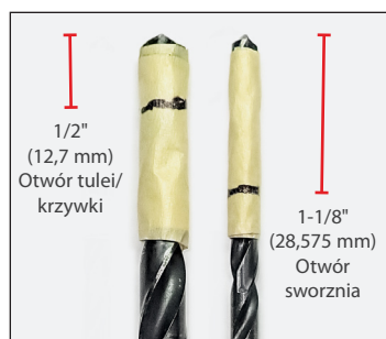
Rys. 8. Zaznaczyć głębokość otworów na wiertłach.
