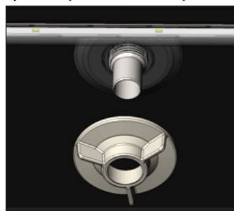
Rys. 2. Przykręcić nakrętkę rurki tacki ociekowej.
