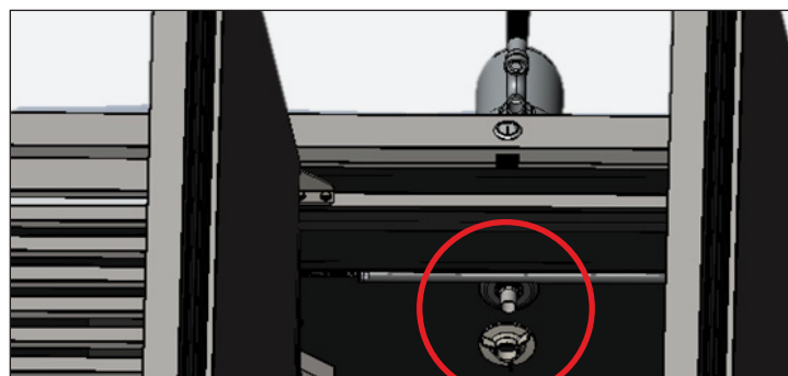
Rys. 1. Miejsce montażu nakrętki tacki ociekowej.
