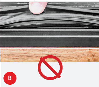
Rys. 12. Pociągnąć za bok uszczelki, aby sprawdzić jej montaż. A: PRAWIDŁOWO; kanał uszczelki NIE jest widoczny. B NIEPRAWIDŁOWO; kanał uszczelki jest widoczny.
