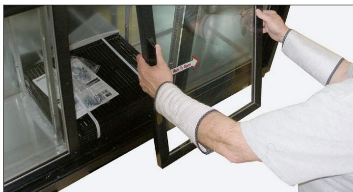
Rys. 2. Ostrożnie zdjąć drzwi.
